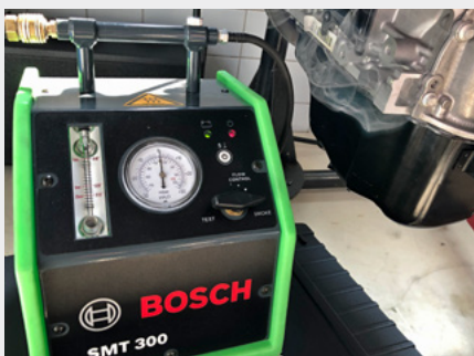
Netěsné víko rozvodů (přisávání falešného vzduchu) motoru 1,2 TSI
