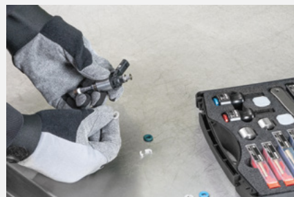
Demontáž O-kroužku a opěrné podložky
