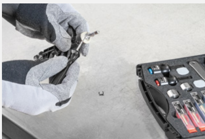
Demontáž vymezovací podložky
