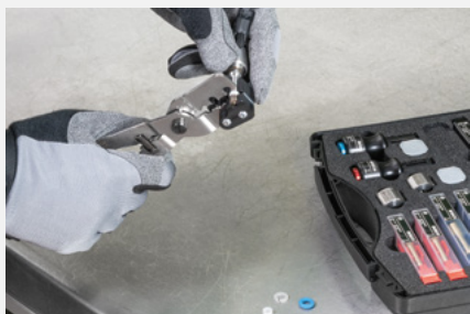
Demontáž teflonového kroužku (těsnicí kroužek spalovacího prostoru)
