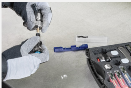
Nasazení nového teflonového kroužku
