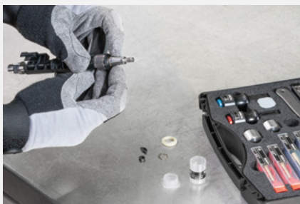
Montáž nové vymezovací podložky
