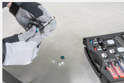
Montáž opěrné podložky a O-kroužku
