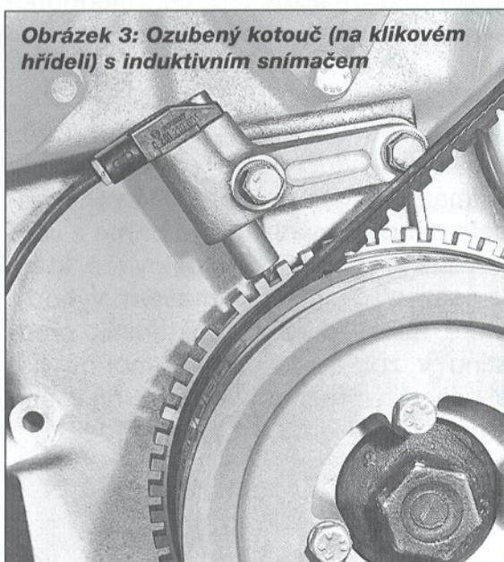
Obrázek 3: Ozubený kotouč (na klikovém hřídeli) s induktivním snímačem
